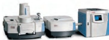
图一 Nicolet™ iS50 FT-IR与TRACE™ 1310 GC组成的iS50 GC-IR模块
